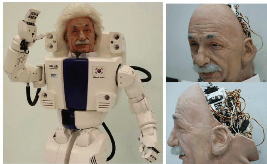
图6 Android 版仿人机器人“Albert HUBO”的头部 [61]
