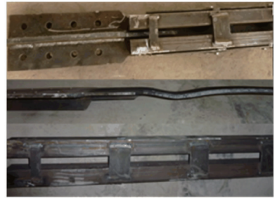
图7 1#试件破坏后拆分的照片
