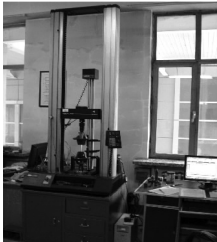
图 4 Instron5569 电子拉伸试验机
