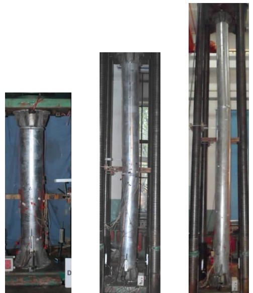
图 6 试件失稳破坏形态
