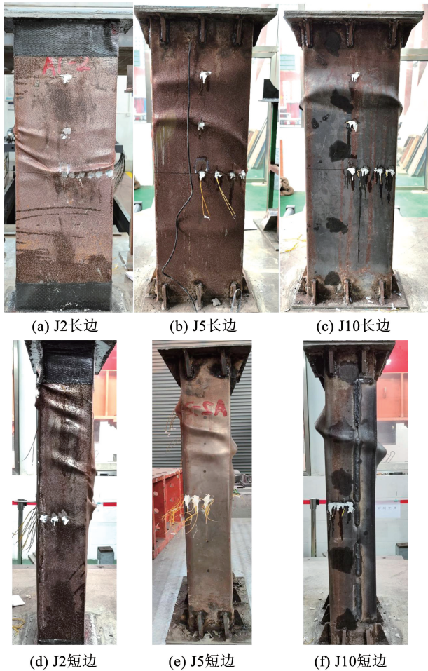
图 4 薄壁钢箱混凝土的破坏模式
