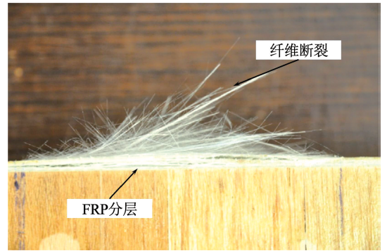
图 5 FRP 分层与 FRP 夹芯板表面纤维断裂
