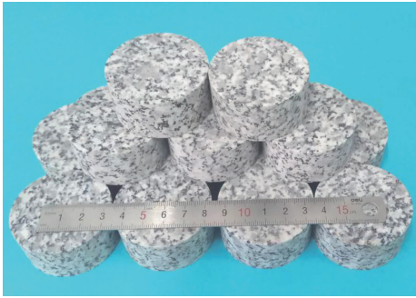
图 1 用于循环冲击的花岗岩试样
