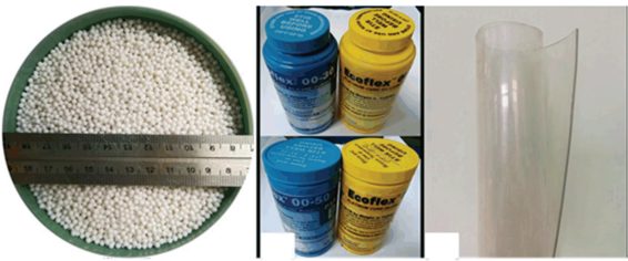
(a) 亚克力球 (b) 弹性硅胶材料 (c) 聚氨酯材料
