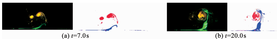
图 13 流显实验图与旋涡提取生成的数字图像比较
