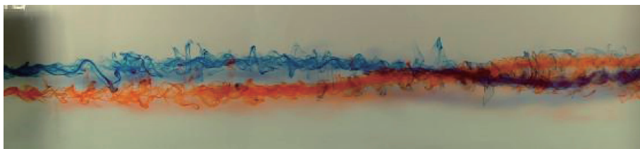
图 2 尾流演变过程的染色液流动显示
